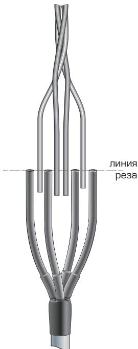
6.1 Расплести провод на длине необходимой для соединения. Расположить провода СИП с нахлестом на жилы кабеля. Обрезать провода СИП на уровне концов жил кабеля.
